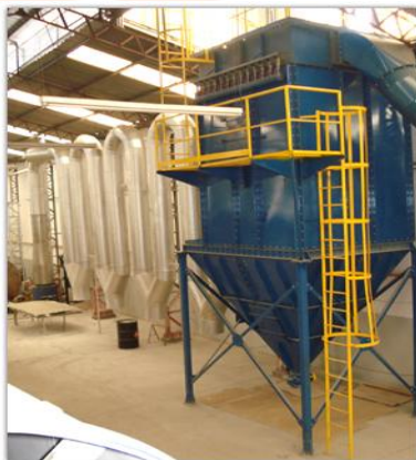
DOBLE SISTEMA DE CAPTACION DE MATERIAL PARTICULADO, POR INERCIA Y FILTRO DE MANGAS
