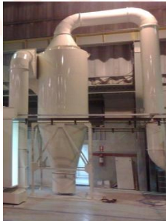
DETALLE DE OTRO SISTEMA INERCIAL DE RETENCION DE PARTICULADO: CICLON (CONVENCIONAL)
