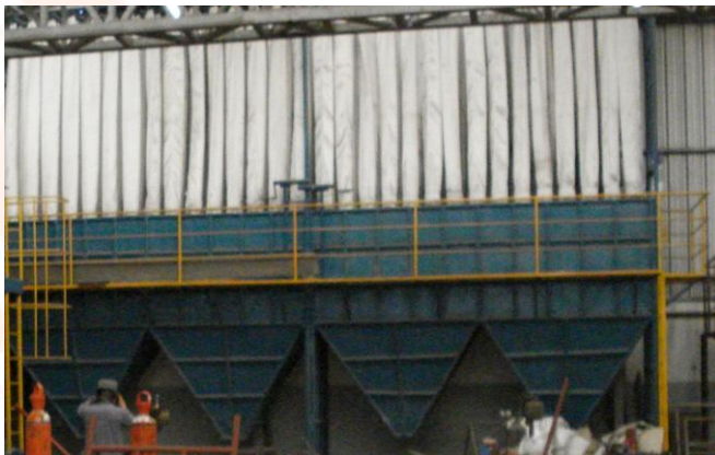
DETALLE DE FILTRO DE MANGAS PARA LA RETENCION DE MATERIAL PARTICULADO
