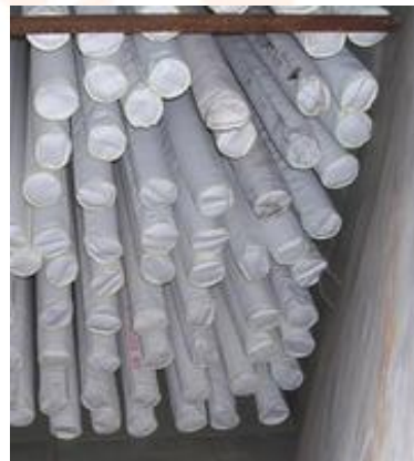
DETALLE DE FILTRO DE MANGAS PARA LA RETENCION DE MATERIAL PARTICULADO
